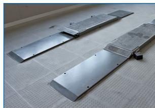
Überfahrrampen um die Überfahrhöhe der bodenauflegend montierten Hebebühne um 40 mm (TWIN F IV 3.5 A) zu verringern.
