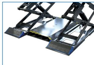
Mit dem Mobilrahmen ist die Hebebühne mit einem herkömmlichen Hubwagen oder Stapler einfach und schnell örtlich versetzbar. Eine Verankerung der Hebebühne am Fußboden ist nicht notwendig. Der Montagerahmen ist freitragend und benötigt lediglich einen befestigten Untergrund. Die Überfahrhöhe der Bühne vergrößert sich nur um 12 mm (TWIN F IV 3.5 A).
