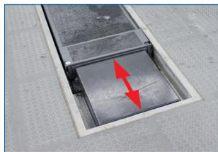
Durch Fundament-Ausgleichskästen (im Lieferumfang) sind die beiden Auszüge auch im abgelassenen Zustand der Hebebühne längenverstellbar. Die Hebebühne kann beim Senkvorgang komplett abgelassen werden, ohne vorher die Auszüge einschieben zu müssen (TWIN F IV 3.5 U).
