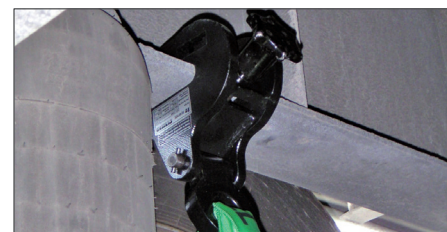
Befestigungsklemmen Zur Befestigung der Gurte am Fahrzeugrahmen.
