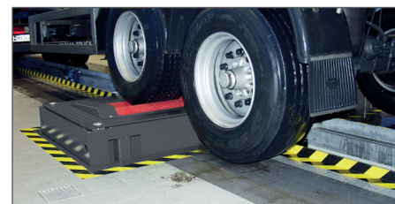
Rollensatzanhebung Hydraulische Rollensatzanhebung zur Verlagerung der Achslast auf die zu prüfende Achse.
