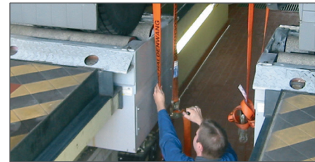
Gewichtssimulator MLS 2100 / 2200 Zweifach-HD-Zylinder zur festen oder beweglichen (auf Schienen) Bodenmontage.
