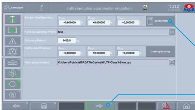
Lastanpassung mit Ermittlung der Prüfstandkoeffizienten. Reale Werte des Fahrzeugs verwendbar und Übertragung auf den Prüfstand möglich
