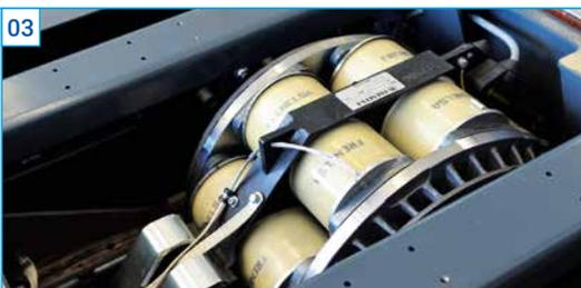
Wirbelstrombremse für Leistungsmessung und Lastsimulation:
