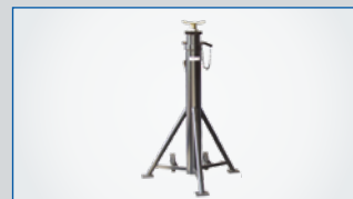
Abstützbock AB 6-20 / 7500 kg Verstellbereich 1200–1965 mm
