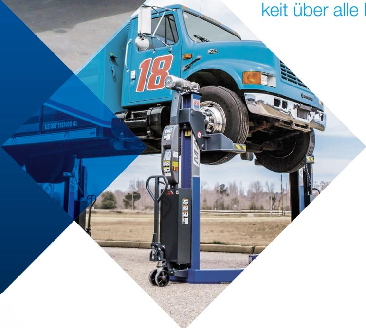
Flexible Säulenpositionierung durch sehr lange Anschlusskabel bzw. Batterieversorgung garantiert die Verwendungsfähigkeit über alle Fahrzeugklassen hinweg
