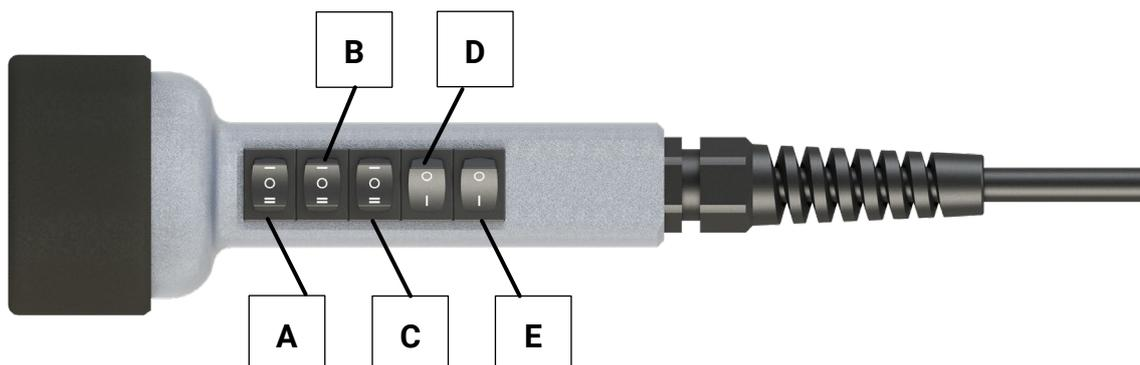
**A / B** Movimiento de las placas de prueba
