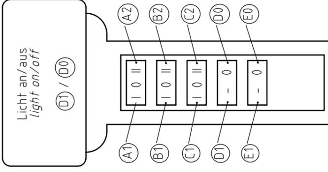
Umschalten zwischen Automatik- und manuellem Modus durch gleichzeitiges Drücken von (A1) und (B2)
